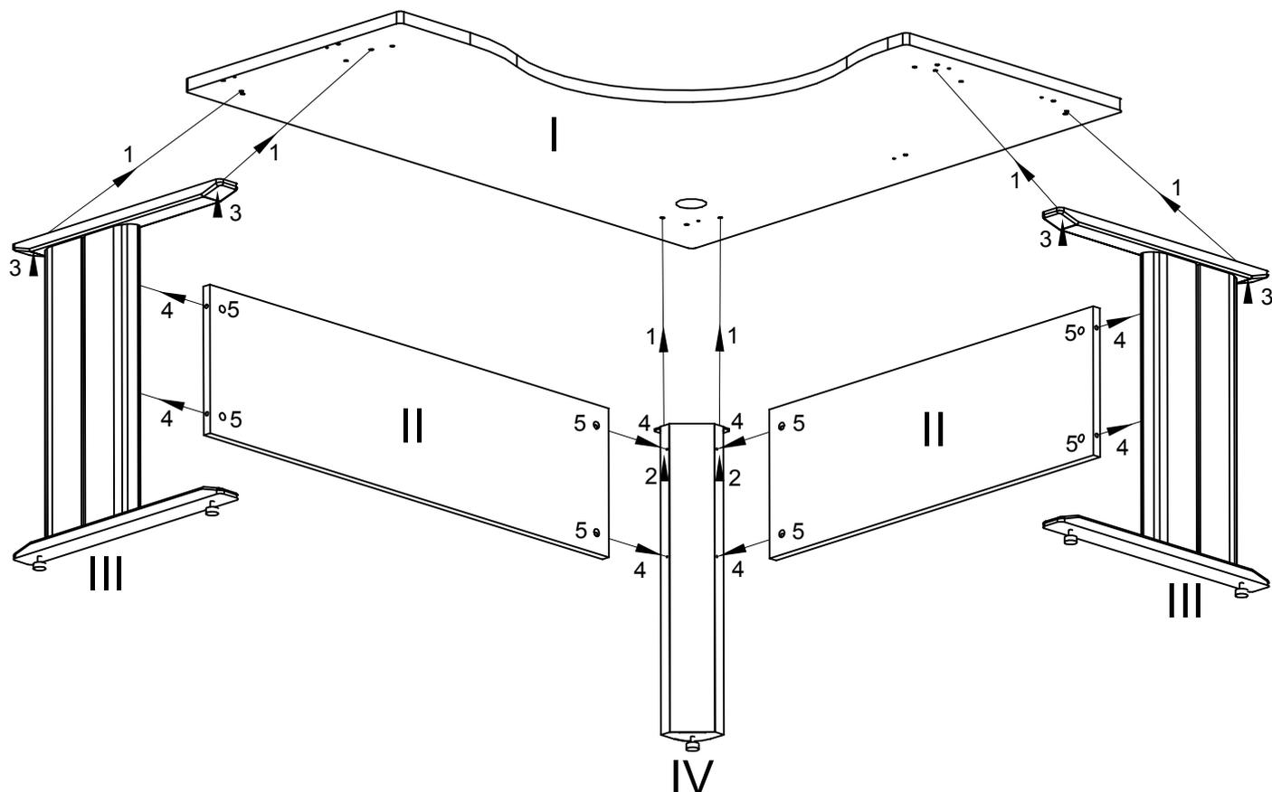
1. Собрать опоры стола (III) согласно приложенной схеме.
