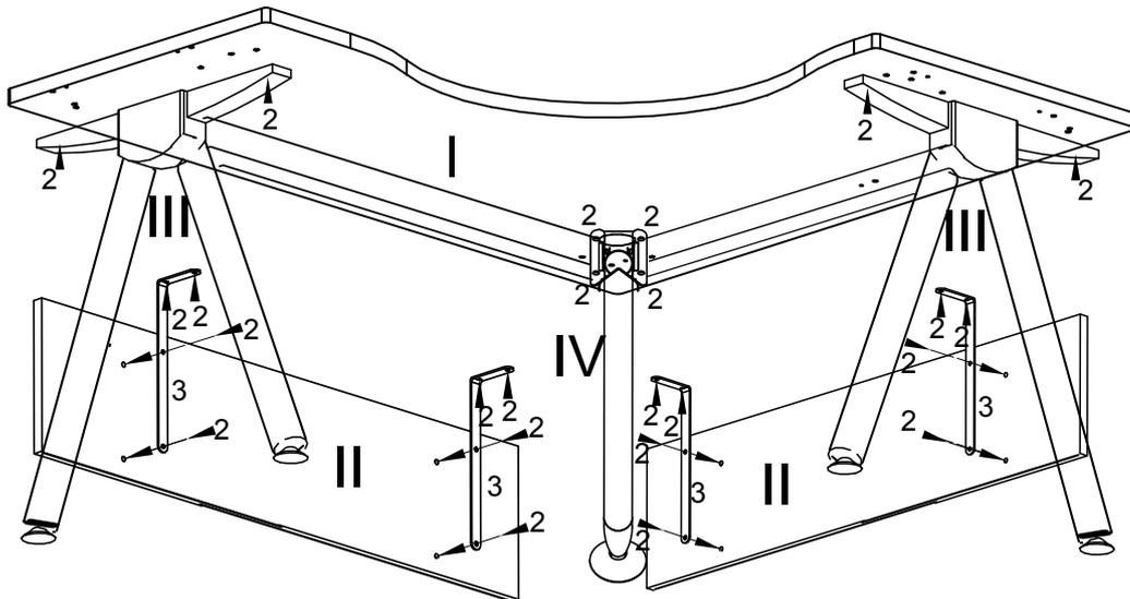
1. Собрать опоры стола (III) согласно приложенной схеме.
