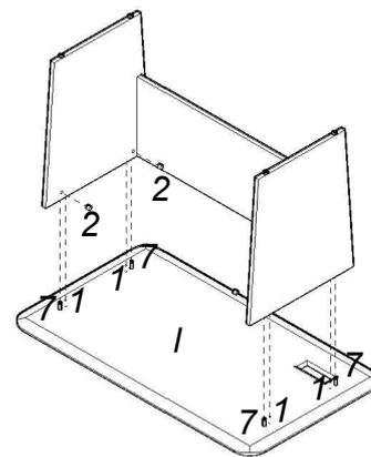
3) Установить стол и вставить кабель канал (5). При необходимости отрегулировать положение стола опорами.
