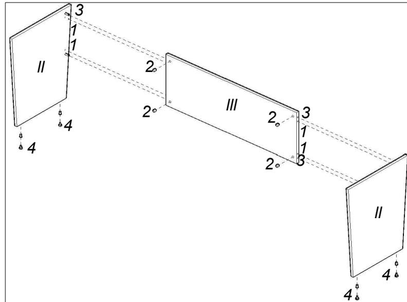
2) Стол рекомендуется собирать на столешнице. Положить столешницу отверстиями вверх. Забить в столешницу шканты (1) и вкрутить футорки (6) и дюбеля стяжек-эксцентриков (7). Соединить каркас со столешницей и затянуть отверткой стяжки-эксцентрики (2) на боковинах. Закрывать торцы стяжек-эксцентриков декоративными заглушками.
