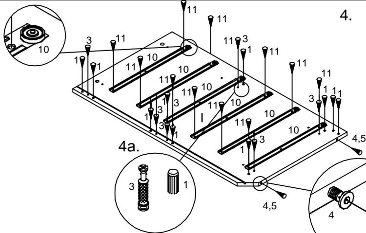
4. Положить стенку боковую левую (I) и стенку боковую правую (II) пазами вверх. Забить в них шканты (1) и вкрутить дюбеля стяжек-эксцентриков (3). В нижние торцы стенок вбить крепеж опоры (4) и завернуть в них опоры (5) (Рис. 4, 4а и 4б).
