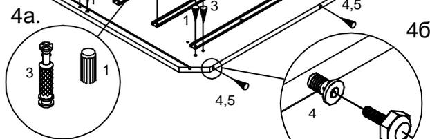
Вставить в стенки боковые (I, II), полки (III, VIII) и царги (VI, VII) стяжки-эксцентрики (2) стрелкой в направлении отверстий на торцах (Рис. 5 и 5а). Соединить полки и царги со стенкой боковой правой (I), стянуть, поворачивая отверткой стяжки-эксцентрики (2) по часовой стрелке. Присоединить к стенке боковой правой (I) планку цокольную (IV) (Рис. 5).
