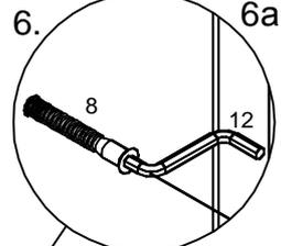
Стяжки-эксцентрики (2) закрыть заглушками (20), стяжки (8) закрыть заглушками (9). Положить каркас лицевой стороной вниз, измерить длину диагоналей корпуса, выровнять их и только после этого закрепить стенку заднюю (V) уголками (7) на расстоянии 50 мм от углов, остальные распределить равномерно (Рис. 7, 7а).
